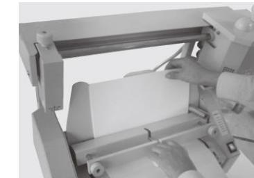
3. Придвинуть блок с обложкой вплотную к боковому упору. Подбить блок сбоку и сверху. Затем зажать блок, сдвинув пресс-зажим вплотную к блоку, зафиксировать блок отжав ручку пресс-зажима, при этом пресс-зажим следует придерживать левой рукой (см. рис.).
